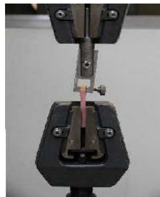
Detalle de la máquina universal para la prueba de bonding.
